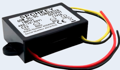
Equipo — Módulo 48 V (28-80 V) → 12 V 5 A
