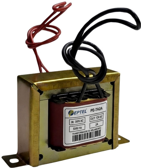
PE-TA2A — placa IN 380 V AC · OUT 12 V AC · 2 A Rojo = entrada 380 V · Negro = salida 12 V
